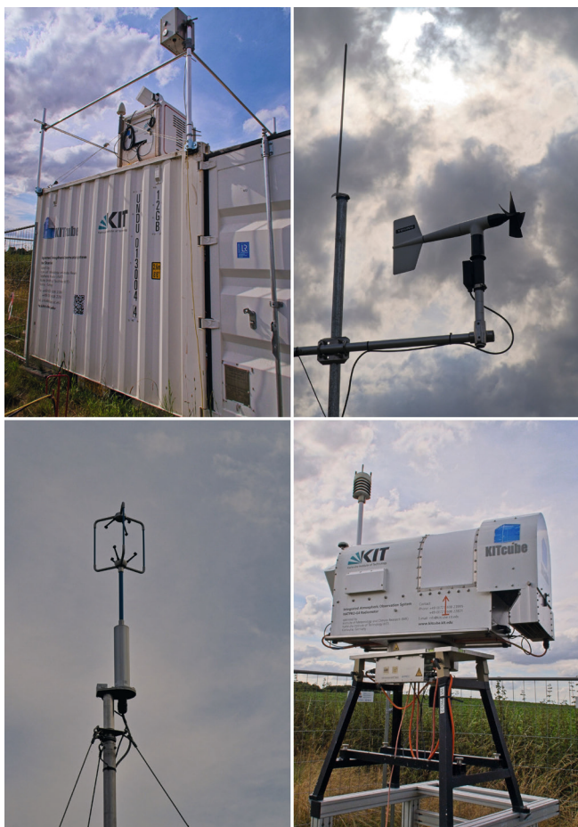
Abb. 6: Verschiedene Messsysteme auf dem VITAL-II-Messfeld. oben: das Doppler-Wind-Lidar des „KITcube“-Beobachtungssystems und ein klassischer Windmesser; unten: ein 3D-Ultraschallanemometer und ein HATPRO-Mikrowellenradiometer für vertikale Temperatur- und Feuchteprofile.
