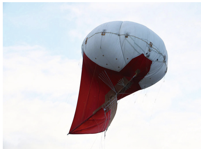
Abb. 2: Die einzigartige Messplattform „Max Planck CloudKite“ ermöglicht es, die Verteilung mikroskopisch kleiner Partikel in Wolken mit einer bisher unerreichten Auflösung zu messen (© MPI-DS).
