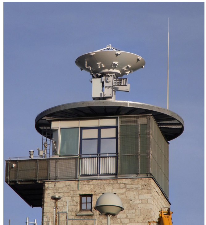
Abb. 1: Die auf 90° Höhenwinkel stehende Antenne bei einem Birdbathscan. Gezeigt ist hier das C-Band Radar am DWD Observatorium Hohenpeißenberg während der Systemerprobung ohne Radom (© M. Frech).
