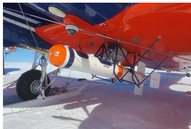
Abb. 2: Schlepplsonde T-Bird des AWI mit Instrumenten vom TROPOS (© Alfred-Wegener-Institut Prof. Dr. Stephan Borrmann, MPI für Chemie).
