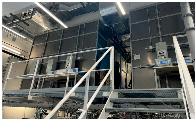
Abb. 6: Die Aerosol-Doppelkammer des TROPOS (© Samira Ellmer).
