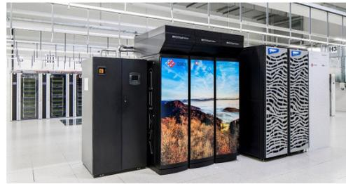
Abb.: Der neue Hochleistungsrechner Cray CS-Storm (rechts) von MeteoSchweiz am CSCS in Lugano. In der Mitte der bisherige Rechner (© Cray/MeteoSwiss).
