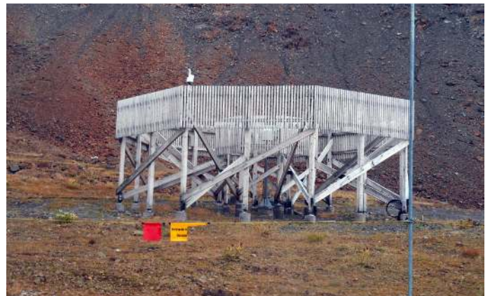
Abb. 3: Niederschlagsmesser DFIR auf dem Mess- und Versuchsfeld des SLF Weissfluhjoch.
