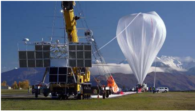
Abb. 4: Ein Super-Pressure Balloon (SPB) der NASA bei den Startvorbereitungen. Im Vordergrund sind als Teil der Nutzlast die Solarpaneele zu erkennen, die zur Stromversorgung der wissenschaftlichen Instrumente dienen (© NASA).
