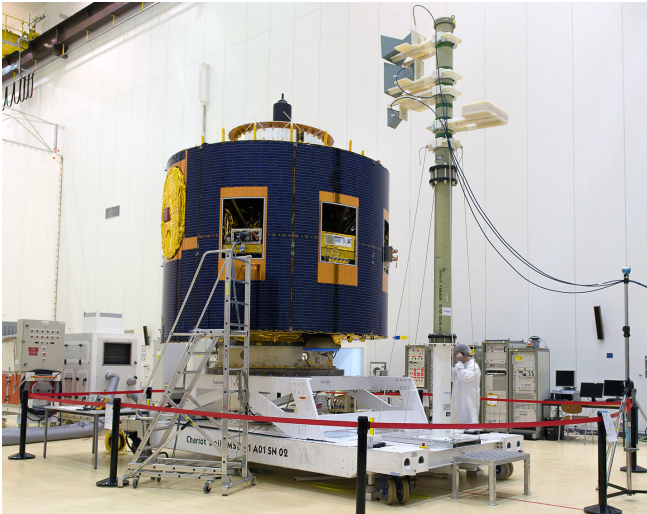
Abb.: 1 Antennentest beim MSG-4. © ESA-CNES-Arianespace/Optique video du CSG S MARTIN.
