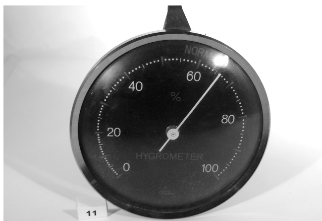
Abb. 2: Dosenhygrometer mit gewalzter Polyamidfaser der Firma Fischer, Drehbach.
