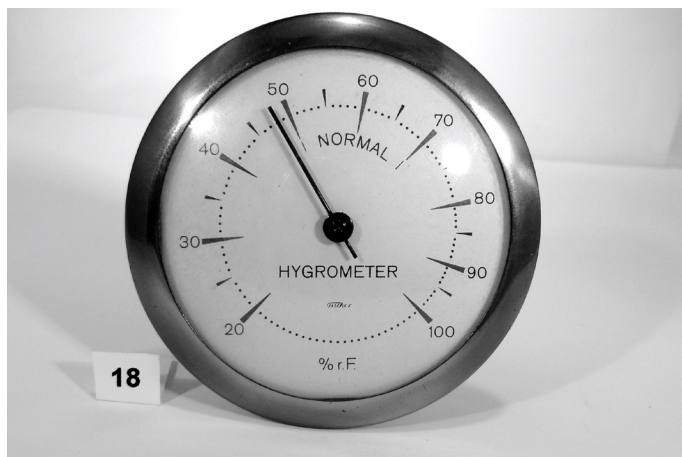
Abb. 3: Dosenhygrometer mit Bispirale der Firma Fischer, Drehbach.
