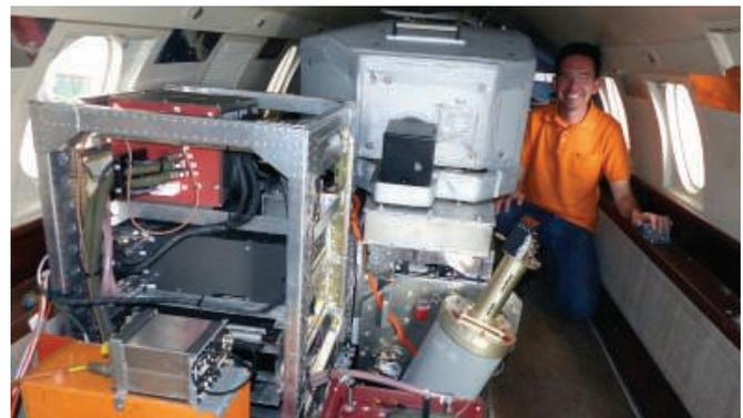
Abb. 2: DLR-Projektleiter Dr. Oliver Reitebuch neben dem neuen Wind-Lidar-Gerät der Falcon (© DLR).
