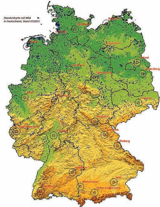
Abb.: Karte der Standorte der Wetterradare des DWD. Die Kreise geben Entfernungen von 5 km und 15 km vom Radar an, welche als Schutzzone bei Genehmigungsverfahren von Windenergieanlagen (WEA) zu berücksichtigen sind. Dunkle Punkte markieren Standorte von WEA in Deutschland (© DWD).
