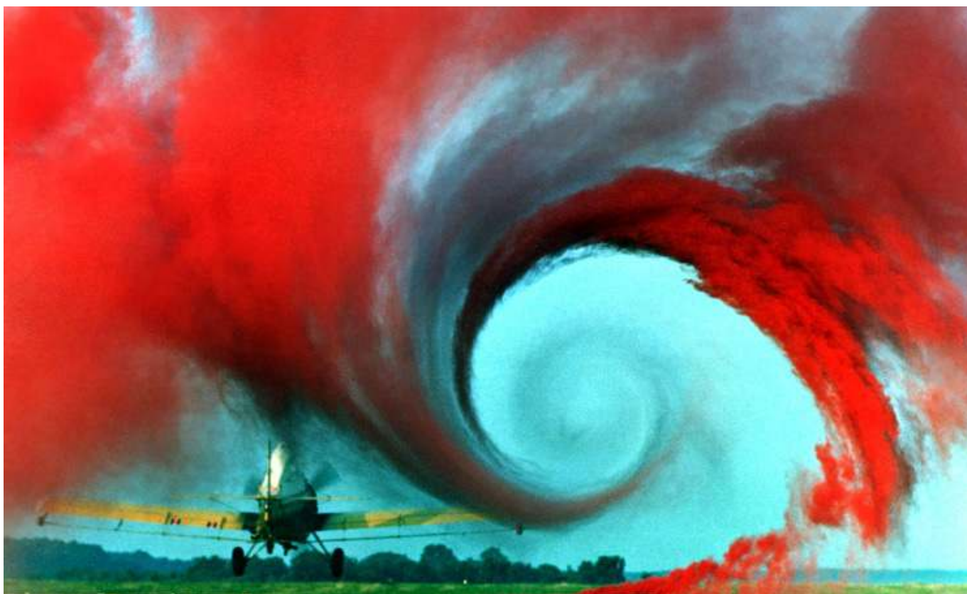
Abb.: Wirbelschleppe hinter einem Flugzeug, sichtbar gemacht mittels Rauchpatronen in einem früheren Feldexperiment der NASA (© NASA).
