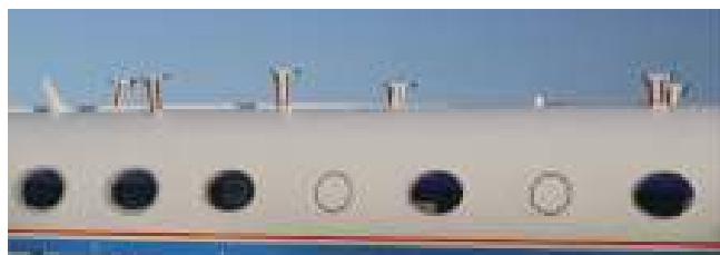
Abb. 2 Über Einlässe im Flugzeugrumpf wird Atmosphärenluft zur chemischen Analyse in den an Bord befindlichen Messgeräten angesaugt (© Hermann Oelhaf, KIT).
