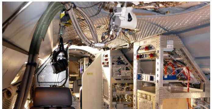
Abb. 2: Der Innenraum von HALO mit den Aufbauten für wissenschaftliche Geräte (© DLR (CC-BY3.0)).
