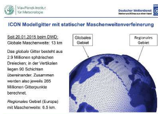
Abb. 1: ICON-Modellgitter mit statischer Maschenverfeinerung (© DWD).
