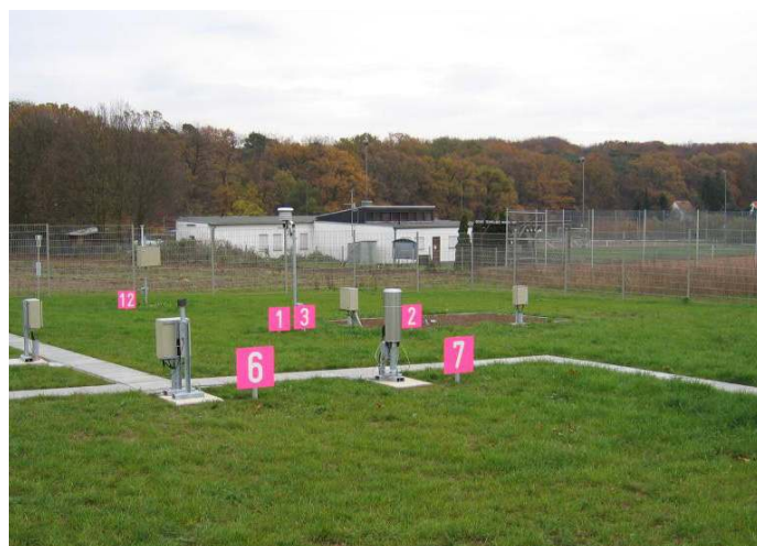
Abb. Automatische meteorologische Datenerfassungsanlage (AMD) des DWD am Standort Offenbach (© DWD).
