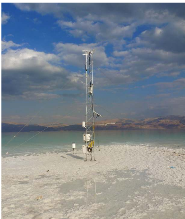
Abb.: Die tiefstgelegene meteorologische Messstation der Erde: Direkt am Toten Meer steht ein sechs Meter hoher Messmast. Die Instrumente messen unter anderem Strahlung, Verdunstung und Wärmestrom (© Dr. Ulrich Corsmeier, KIT).
