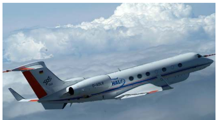
Abb. 1: Das Forschungsflugzeug HALO, ein modifizierter Business Jet vom Typ G 550 der Firma Gulfstream Aerospace (© DLR).
