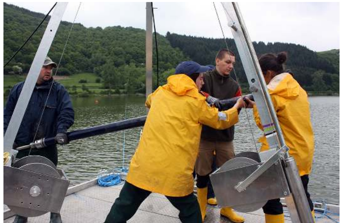
Abb. 1: Entnahme eines Sedimentkerns auf der Bohrplattform am Meerfelder Maar (©: Achim Brauer, GFZ).
