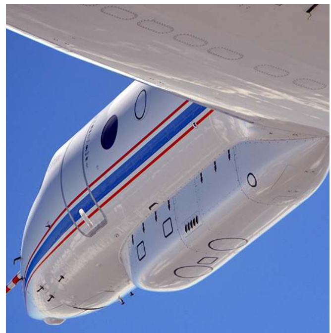
Abb. 2: Der sogenannte Belly Pod am Flugzeugrumpf des HALO, in dem verschiedene Messgeräte untergebracht sind (© DLR).
