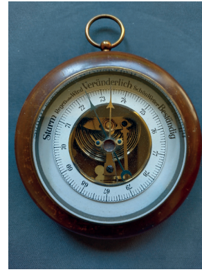
Abb. 5: Scholz Barometer, 8 cm Facettenglas, Skala mit aufgesetzten Metallrad emailiert, etwa 1910.
