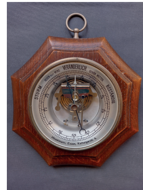
Abb. 7: MOCO-Barometer, offenes Werk, Hinterglasdruck, achteckiges Gehäuse, um 1940.
