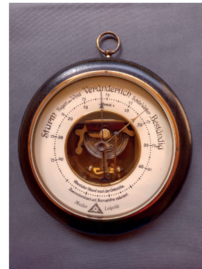
Abb. 6: SundO Barometer mit 80er Doppelskala Metall bedruckt, Facettenschliff um 1920.
