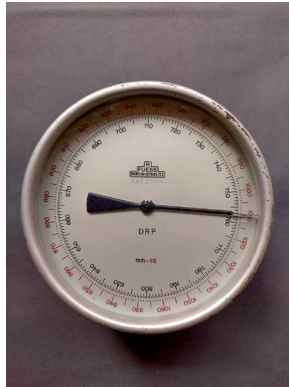
Abb. 2: Fuess Barometer-Höhenmesser mit Präzisions-6-Membranen-Werk, um 1930.
