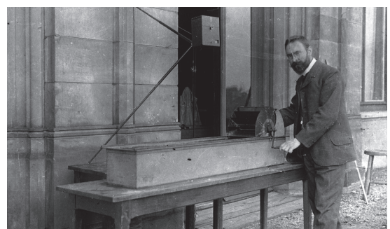
Abb. 2: Ludwig Prandtl im Jahr 1904 vor dem von ihm in Hannover entwickelten Wasserversuchskanal zur Untersuchung der Grenzschicht. Die Wasserbewegungen wurden mit Eisenglimmer sichtbar gemacht, sodass diese gezeichnet bzw. fotografiert werden konnten (Quelle: DLR, CC BY-NC-ND 3.0).
