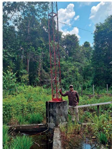
Abb. 2: Yohanes Ginting am Messturm für die Eddy-Covarianz-Messungen (© Rimba Makmur Utama).
