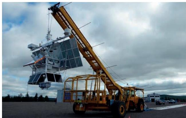
Abb. 1: Die am Startfahrzeug hängende Ballongondel (© DLR, CC-BY 3.0).
