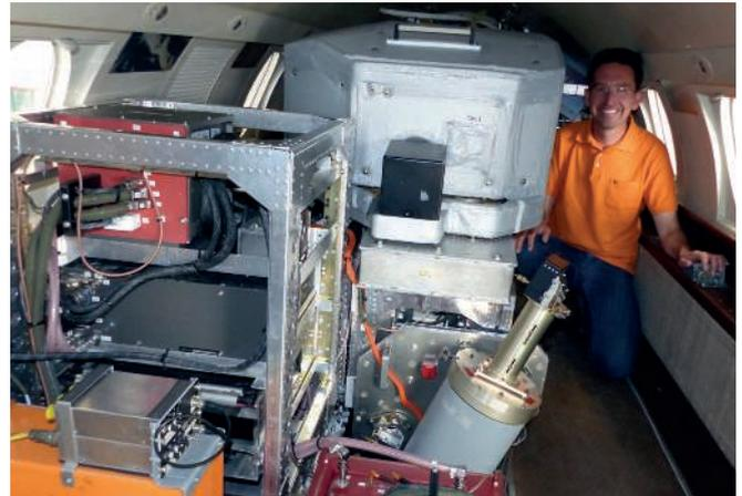
Abb. 2: **ALADIN** Projektleiter Dr. Oliver Reitebuch vom DLR Institut für Physik der Atmosphäre des DLR bei Testflügen neben dem Wind-Lidar im DLR For- schungsflugzeug Falcon (© DLR (CC-BY 3.0)).
