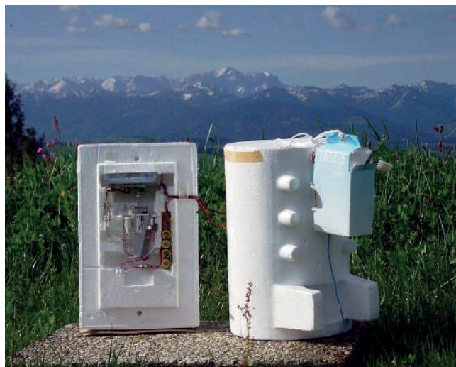
Abb. 4: Heutige Ballon-Sonde des DWD zur Messung des vertikalen Ozon-Profils (© DWD).
