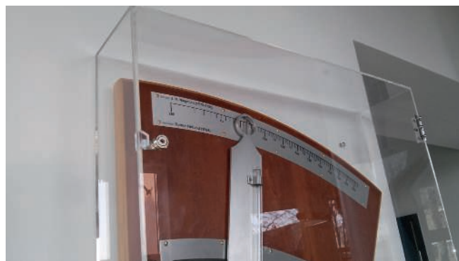
Abb.: Das von J.H. de Magellan (1722-1790) vorgeschlagene Sektorbarometer in einer Ausführung von Rainer Holland (© Bernd Stiller).
