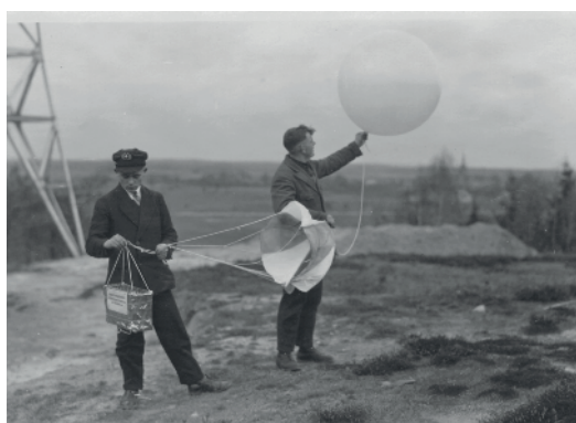
Abb. 4: Start eines Pilotballons mit einer Vorgängerin der Radiosonde, Aufnahme etwa aus dem Zeitraum 1927-1929 (© DWD).
