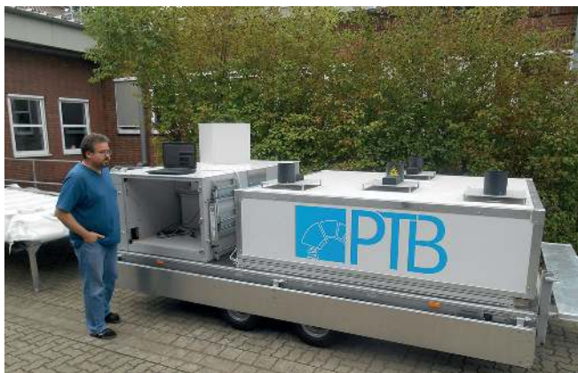
Abb. 1 Bistatisches Wind-Lidar der PTB mit einer Sonde und 3 Empfangseinheiten (© Christian Koch).
