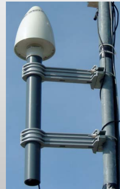
GPS-Antenne: absoluten Zeitbasis mit 100 ns Präzision
