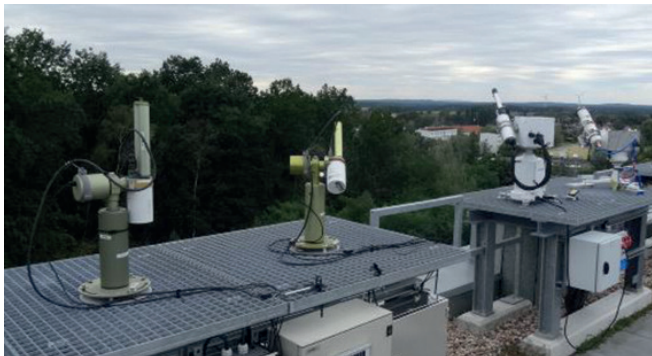
Abb. 1: Vier lunare und solare Photometer auf der Messplattform der Strahlungsmesszentrale am MOL-RAO zielen tagsüber auf die Sonne (von l. nach r.: Zwei Cimels vom DWD, ein Prede vom japanischen Polar Institut NIPL und ein PFR vom Davoser Observatorium PMOD/WRC), © DWD MOL-RAO.
