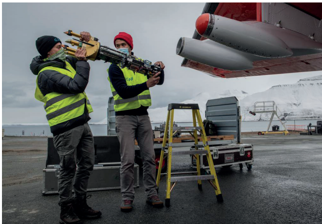
Abb.1: Manuel Moser (l) und Valerian Hahn vom DLR, Deutsches Zentrum für Luft- und Raumfahrt, montieren die PMS-Sonde am Polar 5-Forschungsflugzeug (© Esther Horvath).
