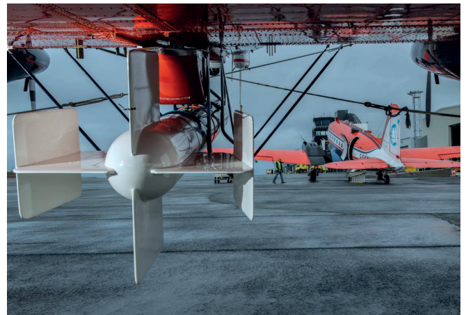
Abb. 2: Die Forschungsflugzeuge Polar 6 und Polar 5 in Spitzbergen. Im Vordergrund steht der "EM Bird" der "IceBird"-Kampagne, der auf der Polar 6 montiert ist. (© Esther Horvath).
