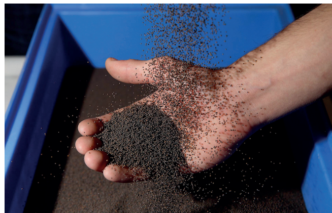
Abb.: Keramikpartikel als Wärmeträger (©: DLR/FrankEppler).
