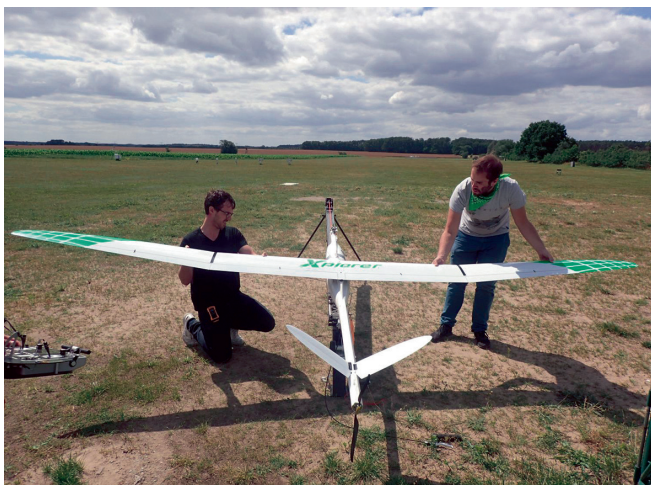
Abb. 2: Startvorbereitungen für das unbemannte Messflugzeug MASC der Universität Tübingen auf dem Messfeld Falkenberg (© DWD).
