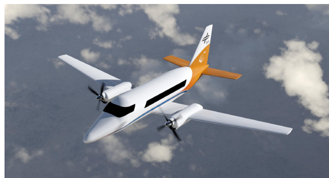
Abb.: Konzeptstudie eines hybridelektrischen 19-Sitzers im Forschungsprojekt CoCoRe (© DLR/BHL).
