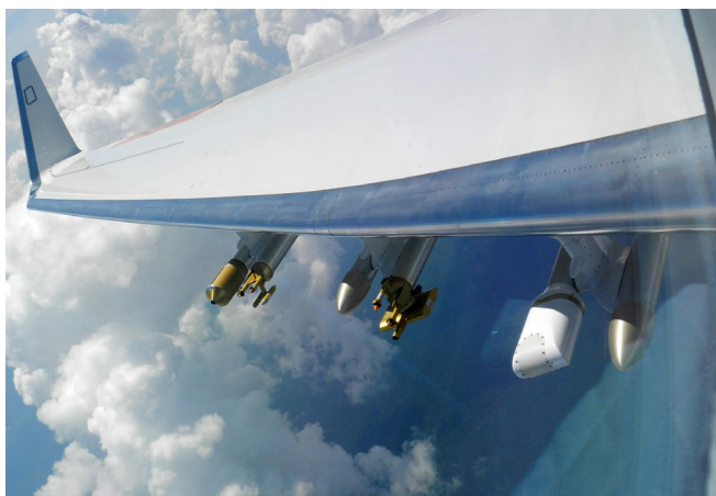
Abb.: Partikelsonden zur Charakterisierung von „Supercooled Large Droplets (SLD)“ © DLR, CC-BY 3.0.
