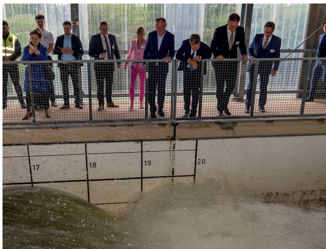
Abb. 2: Die Welle in dem 300 Meter langen Wellenströmungskanal erreicht eine Höhe von drei Metern (© LUH/Thomas Damm).
