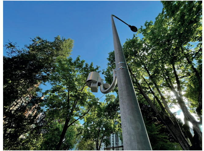
Abb. 1: Messnetz mit Schwerpunkt auf Hitze in der Stadt: Derzeit 42 Stationen im Freiburger Stadtgebiet und der näheren Umgebung erfassen Lufttemperatur, Feuchte und Niederschlag. Foto: Professur für Umweltmeteorologie
