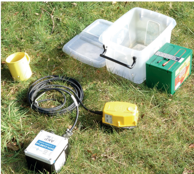
Abb. 2: Die Einzelteile einer seismischen Station (© GFZ).
