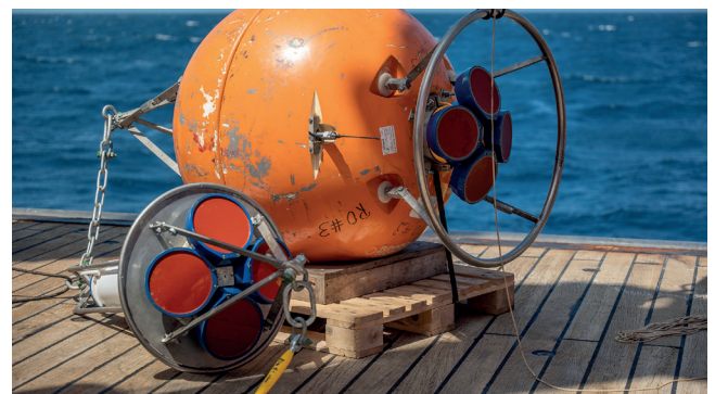
Abb. 2: Akustischer Strömungsmesser bereit zur Auslegung (© David Menzel/GEOMAR).
