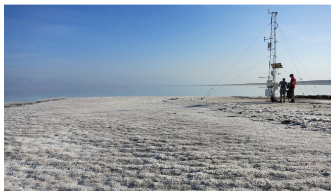
Abb.: Eine der Messstationen am Ufer des Toten Meeres mit Klimasensoren und GNSS-Ausrüstung (© Prof. Jens Wickert/GFZ).
