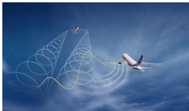
Abb. 2: Das hintere Flugzeug surft auf dem Luftstrom der Wirbelschleppe (Credit: DLR, CC BY-NC-ND 3.0).
