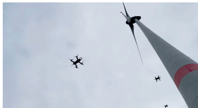
Abb.: Drohnen bei Messungen an einer Windkraftanlage. Credit: DLR (CC BY-NC-ND 3.0).
