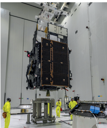
Abb. 1: Montage des 1. Satelliten der MTG-Serie (© Eumetsat).
