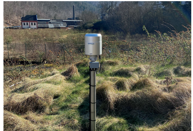
Abb. 2: Niederschlagsmessstation des Wernetz-Hagen im Nahmortal (© Bastian Rissling).
