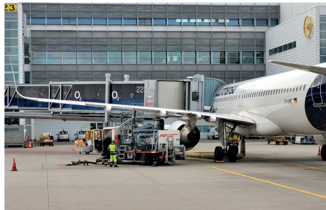
Abb. 3: Nach dem Vortragsprogramm bestand die Möglichkeit zu einer Vorfeldrundfahrt. Hierbei konnte man zum Beispiel auch den Anschluss der Pre-conditioned Air-Anlagen an die Flugzeuge erkennen (Schlauch unter dem Flugzeug), © Bastian Kern.
