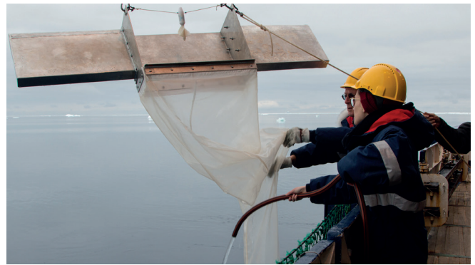
Abb.: Das Planktonnetz zur Beprobung der Wasseroberfläche wird vor der Probennahme abgespült, um eventuell schon vorher anhaftende Partikel zu entfernen. (© Universität Basel, Patricia Holm).
