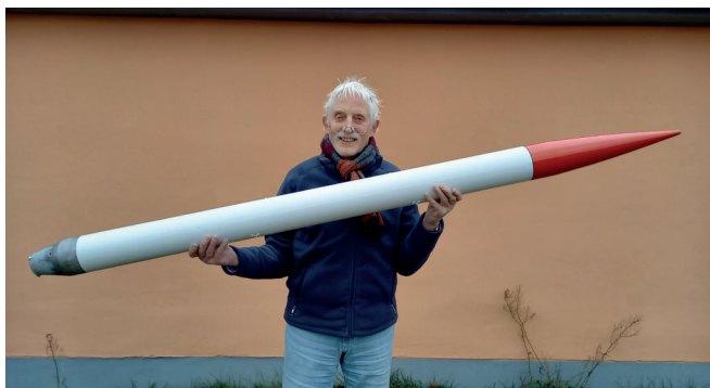
Abb. 3: Vorstandsmitglied Ralf Kraak hat eine Rakete ausgepackt. Das Wetterraketen-system Arcas (hier der Antriebsteil, noch ohne Flossen, das entsprechende Paket wurde erst später entpackt) wurde verwendet, um Wetterinformationen in großer Höhe von bis zu 60 km zu erhalten. Starts erfolgten zwischen dem 31. Juli 1959 und dem 9. August 1991 in den USA, aber auch teilweise im Ausland. (© Bernd Stiller).
