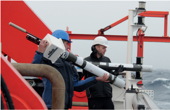
Abb.: Während einer Expedition mit dem Forschungsschiff "Sonne" unter der Leitung des Instituts Senckenberg am Meer konnten mehrere Argo-Floats des BSH gezielt in einem Ozeanwirbel im Nord-Ost-Atlantik ausgesetzt werden, um ein neues Sensorsystem zu testen (Quelle: Mia Schumacher, GEOMAR).
